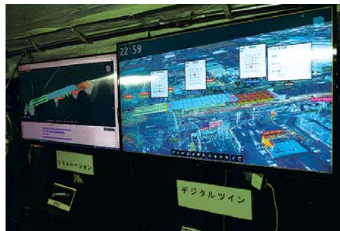
架設作業中は事前に作成したデジタルツインとリアルタイムで比較
